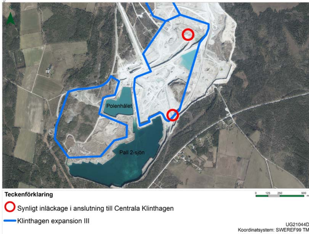
Figur 30. Läge för synligt inläckage i anslutning till Centrala Klinthagen.
