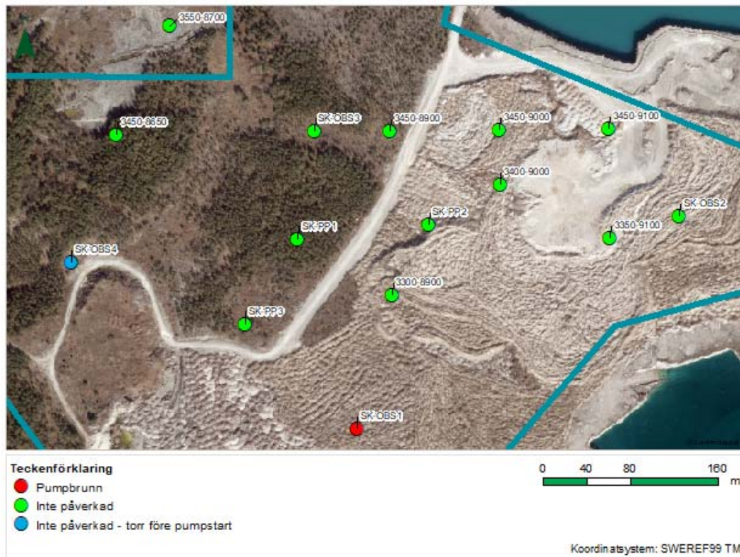
Figur 55. Placering pumpbrunn och observationspunkter vid provpumpningen i SK-OBS1.
