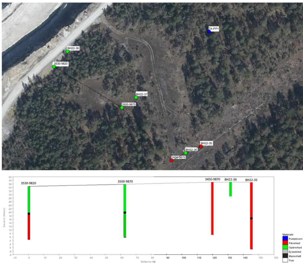
Figur 36. Tvärsektion längs med borrhålen 3530-9820, 3500-9870, 3450-9870, BH22-36 och BH22-35 där sektioner som påverkades av provpumpningen markeras med rött och sektioner som var opåverkade markeras med grönt. Läge för manschetter i tre av borrhålen redovisas med svart.
