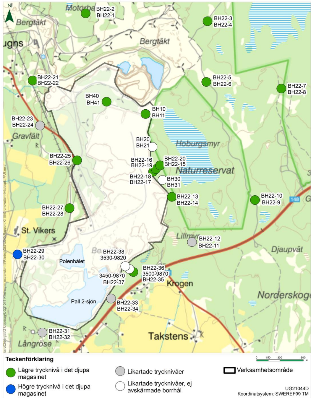
Figur 1. Läge och redovisning av skillnad i trycknivå för borrhålspar med grunda och djupa hål. Ett antal av de djupa borrhålen är inte avskärmade från det yttliga berget och kan då representera antingen ytligt eller djupt magasin eller en kombination av dessa beroende på vilka sprickor som ansluter till borrhålet.
