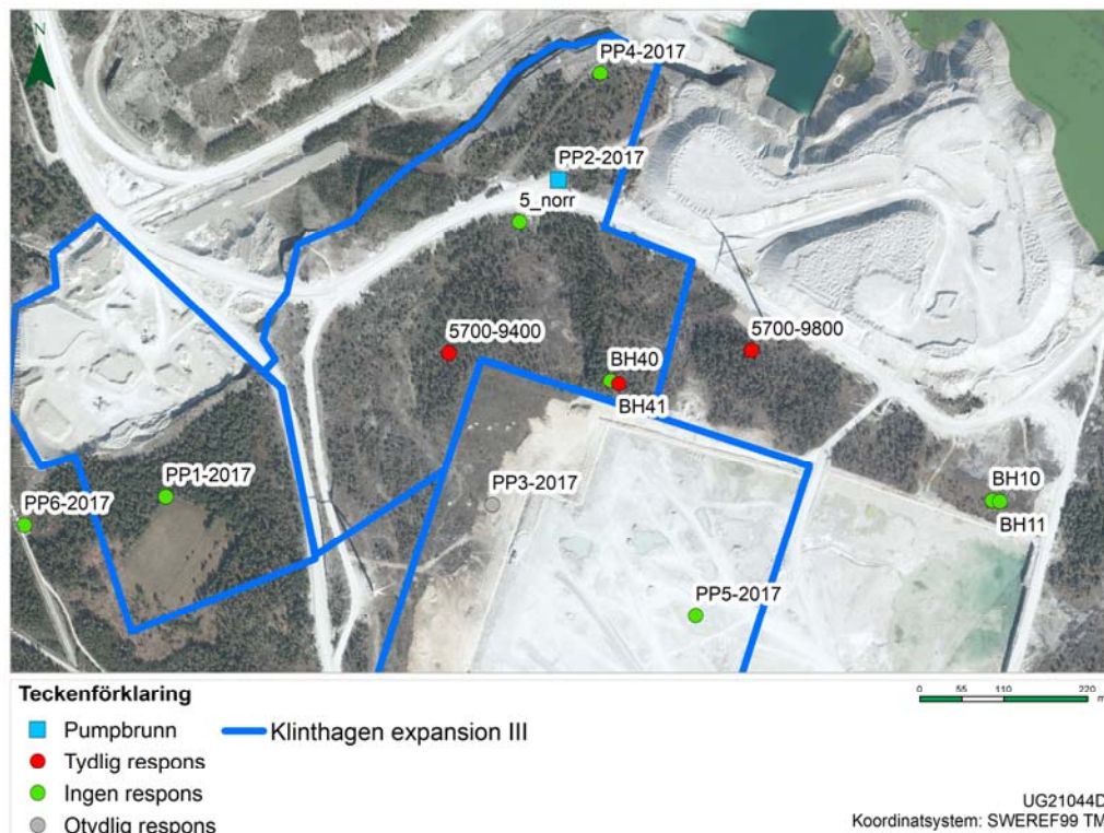
Figur 4. Påverkan på närmast liggande borrhål från provpumpning i bergborrhål PP2-2017.
