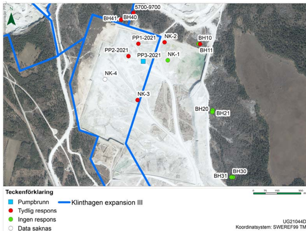
Figur 20. Respons från provpumpning i pumpbrunn PP3-2021.
