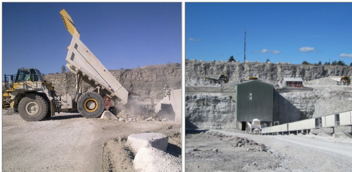
Figur 16. Till vänster tippas losstagen sten i primärkrossen. Till höger visas Krossgropen och den inbyggda primärkrossen från öster. I bakgrunden syns en truck på väg för att tippa sten. Från primärkrossen går en kort bandtransportör upp ur Krossgropen till en vinkelstation (till höger om bilden). I vinkelstationen ansluter den långa bandtransportören till Storugnsverket.
