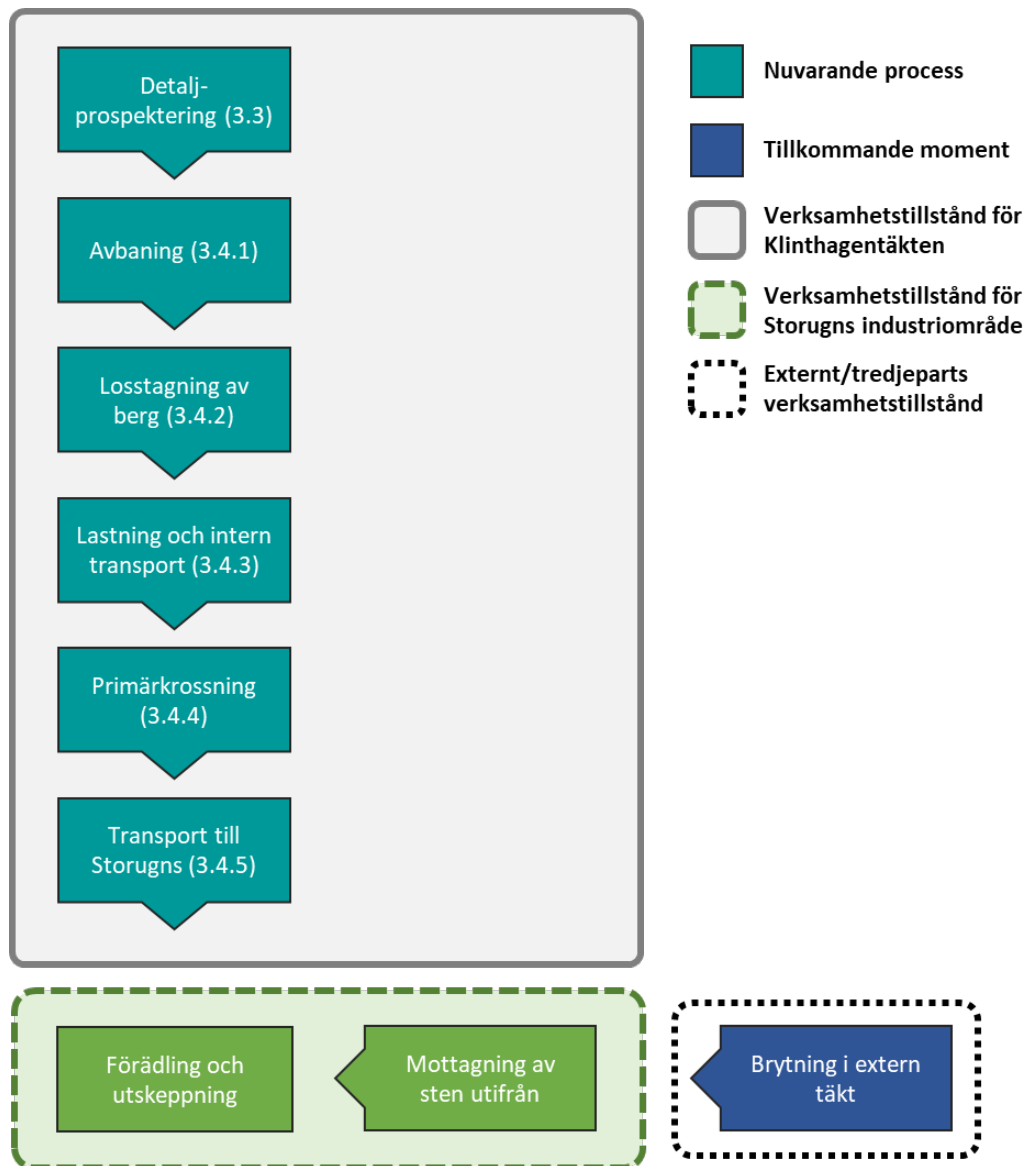
Figur 4. Schematisk beskrivning av arbetsflödet för täktverksamheten i Klinthagentäkten. För de olika arbetsmomenten ges hänvisningar till respektive avsnitt i den här tekniska beskrivningen.
