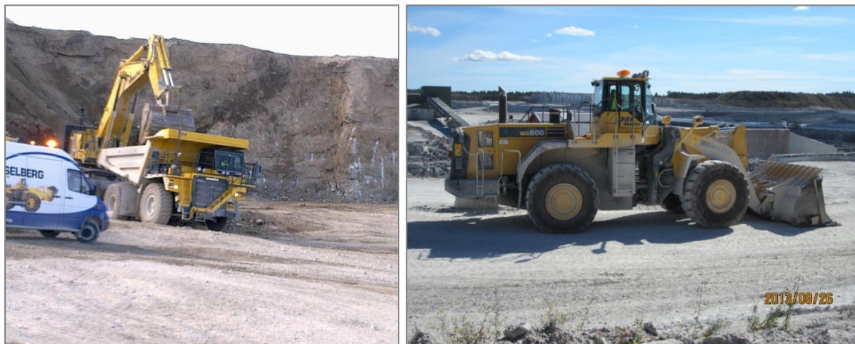
Figur 17. En truck vid lastning av grävmaskin vid brytfront i högra bilden samt en hjullastare som kan rensa vägbanan eller lasta kalksten i truckar i den vänstra bilden. Foton: Nordkalk.
