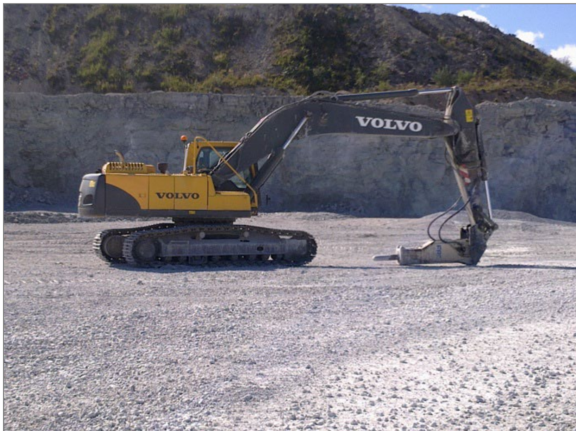
Figur 15. En grävmaskin med hydraulisk hammare som knackar ner de stenblock som är för stora för att kunna krossas i primärkrossen. Foton: Nordkalk.
